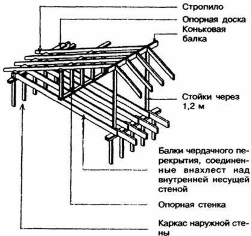
**Рисунок** — Каркас скатной крыши с уклоном менее 1:3 с промежуточной опорой в виде опорной стенки
