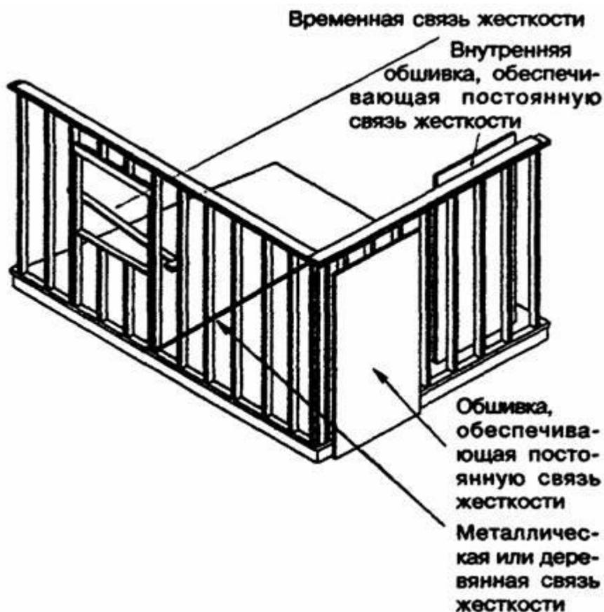
**Рисунок — Каркас стены**
