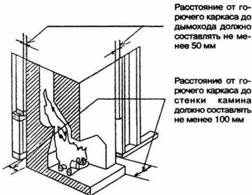
**Рисунок** — Расстояние от стенок камина до каркаса здания
