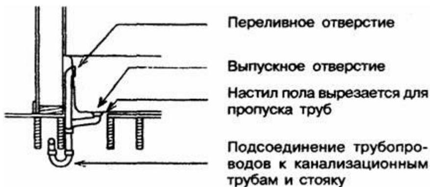
*Рисунок* — Детали установки умывальника и ванны
