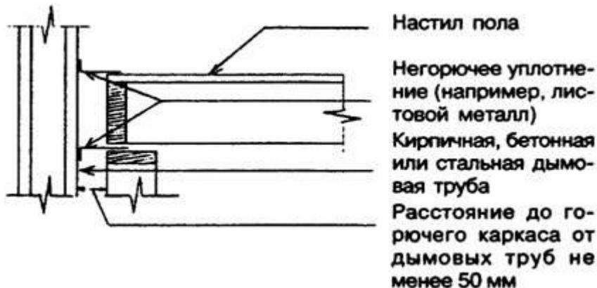
**Рисунок** — Расстояние от дымовой трубы до строительных конструкций
