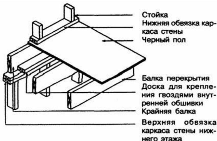
**Рисунок** — Деталь установки доски для крепления внутренней обшивки
