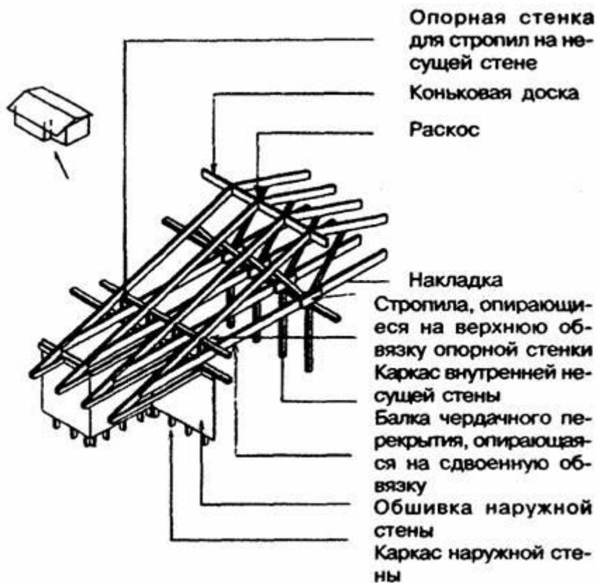
**Рисунок** — Устройство каркаса скатной крыши при смещенной внутрь здания наружной стене
